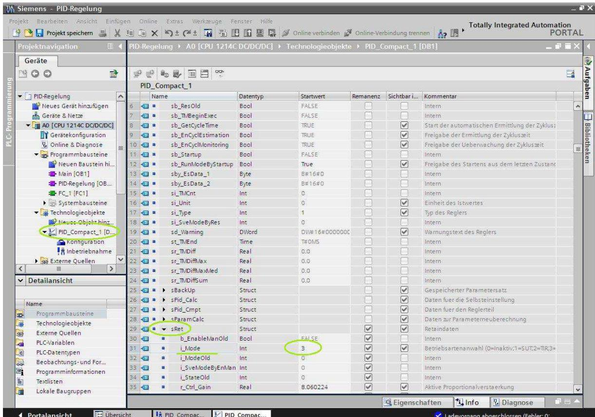
Unter „sRet -> i\_Mode“ setzen wir den Startwert auf 3 (Automatikmodus), damit die SPS immer sofort in diesem Modus startet.
