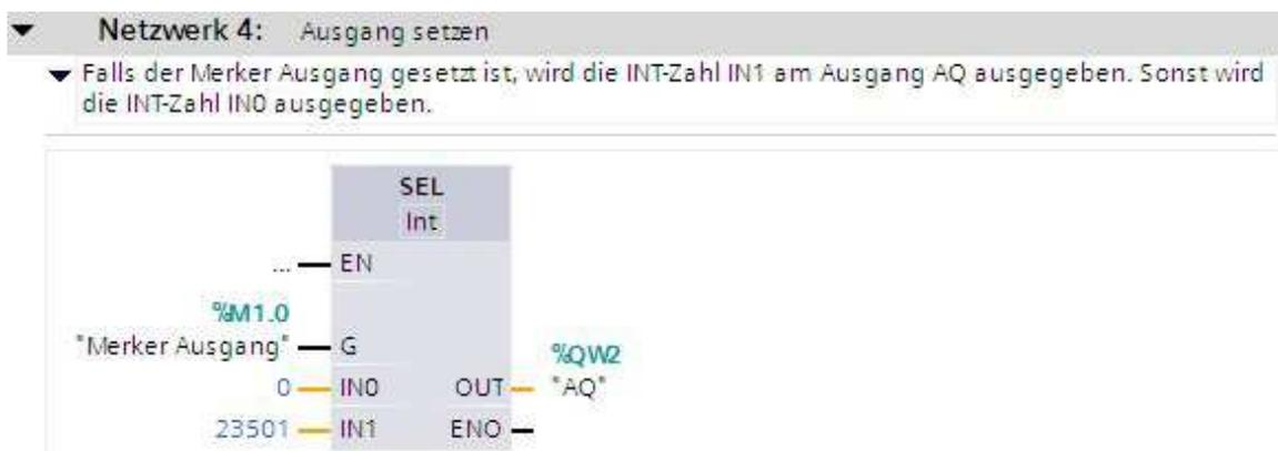
Wir sind fertig mit programmieren und können nach dem Leitfaden „STEP 7 Basic V10.5“ alles auf die S7-1200 übertragen und mit der „Brillenfunktion“ das arbeitende Programm betrachten. Wir haben eine Zweipunktregelung programmiert.
