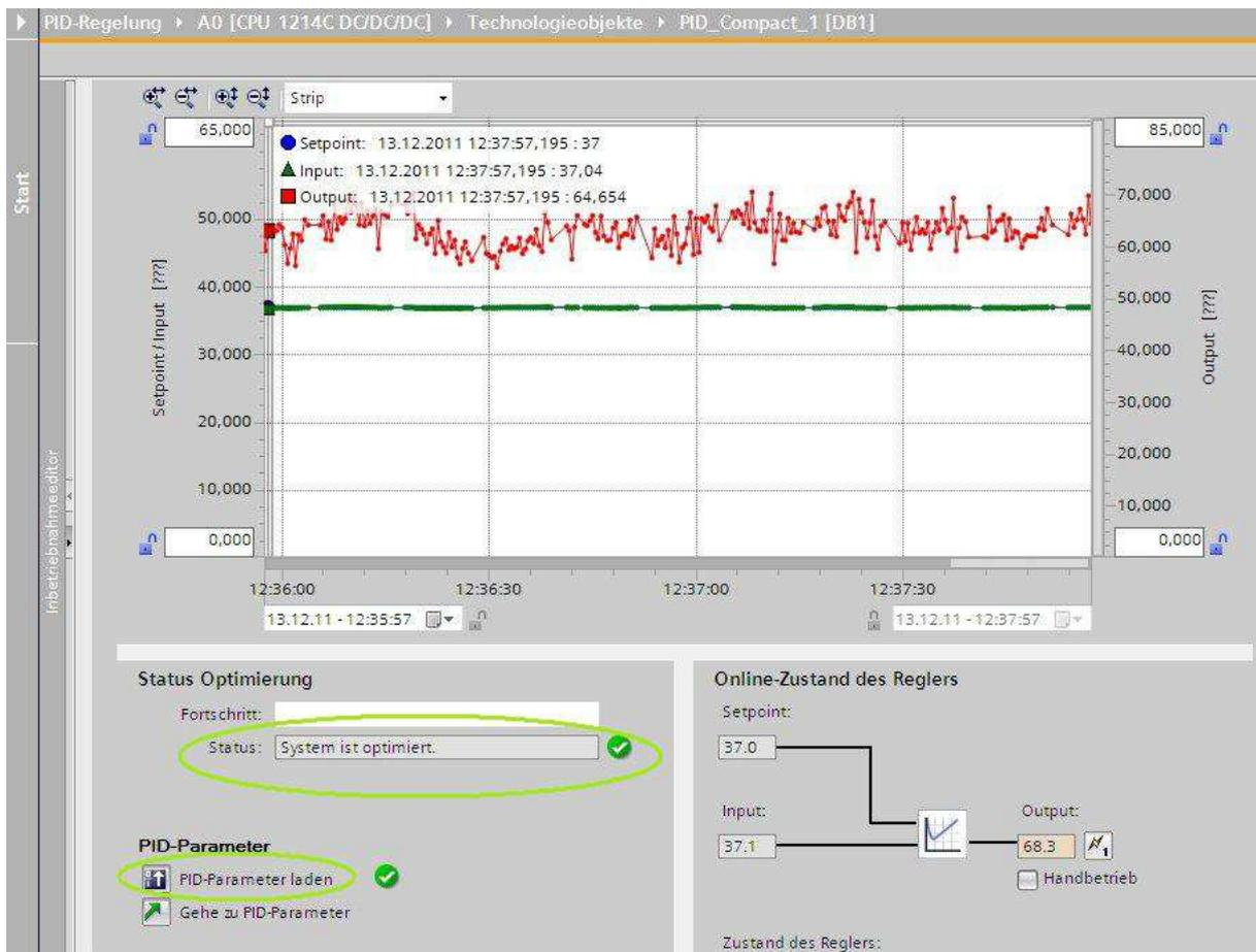
Wir haben erfolgreich eine PID-Regelung programmiert, konfiguriert und in Betrieb genommen. Beobachten sie den Graphen, wie der Ausgang ständig an die Differenz zwischen Soll- und Istwert angepasst wird und wie genau der PID-Regler die Temperatur ausregelt. Es sind nur Differenzen von  $\pm 0,2$  C° zu beobachten.
