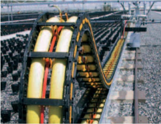
Optimal für den Einsatz bei langen Verfahrwegen. Durch reibungsarme Kunststoffgleitschuhe, in Verbindung mit dem passenden Führungs- und Unterstützungskanal, können Verfahrwege bis zu 400 Metern erreicht werden. Durch Dreifach-Verbindungsbolzen kann die Kette auch mechanisch anspruchsvolle Einsätze meistern.
