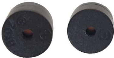
Abbildung 1: Vorderseite vom aktiven Summer (links) und passiven Summer (rechts) Quelle: BBS2 Wolfsburg
