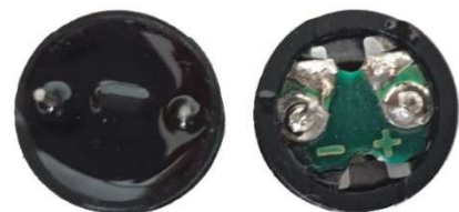
Abbildung 2: Vorderseite vom aktiven Summer (links) und passiven Summer (rechts) Quelle: BBS2 Wolfsburg
