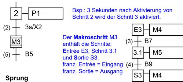
Bsp.: 3 Sekunden nach Aktivierung von Schritt 2 wird der Schritt 3 aktiviert.
