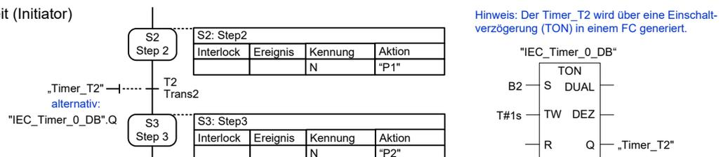
Hinweis: Der Timer\_T2 wird über eine Einschaltverzögerung (TON) in einem FC generiert.
